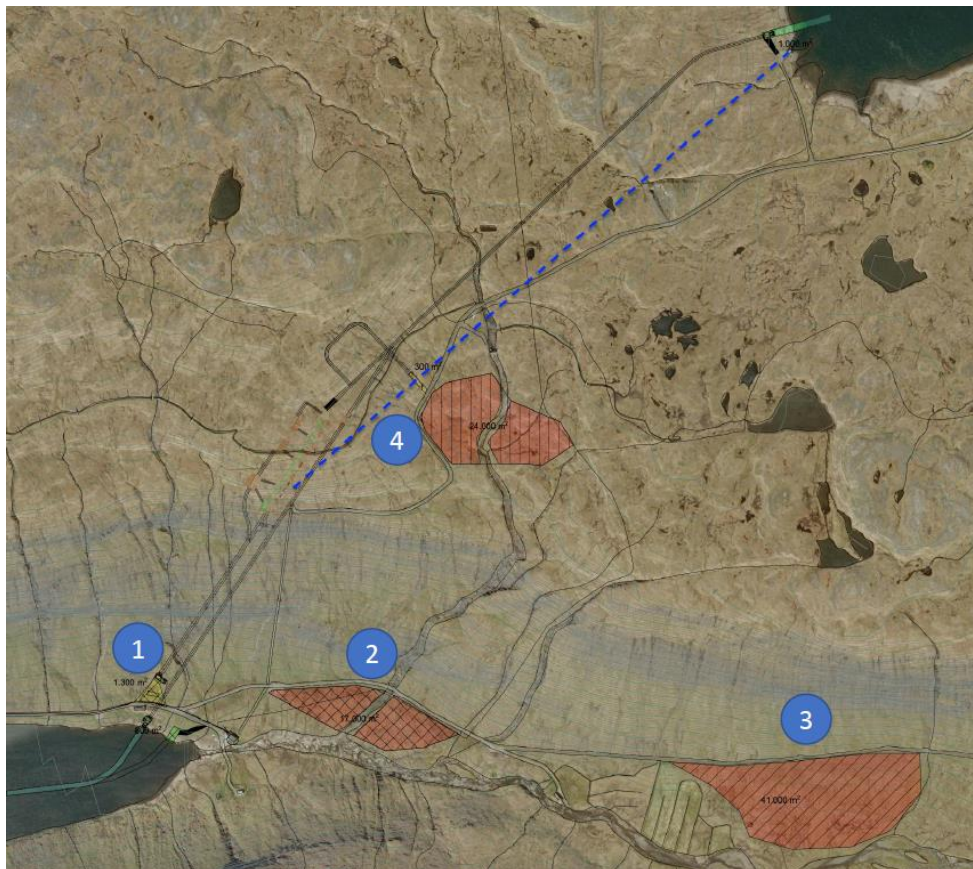
Mynd 5-12, myndin vísir lendistørvin. 1 er tunnismunni við portalbyggingi, 2 er byggipláss og møgulig verðandi goymsla, 3 er verðandi goymsla og 4 er tunnismunni, útlíkingstunnill, byggipláss og møgulig verðandi goymsla.
