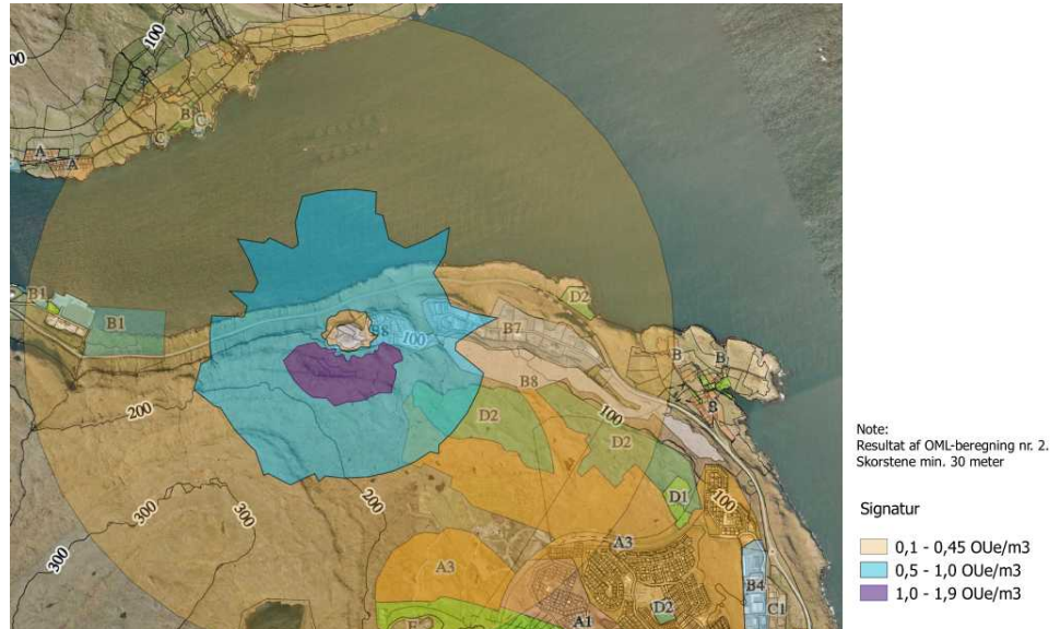
Figur 2: Grafik afbildning af lugt-resultat OML-nr.2 ved opførelse af biogasanlæg med 2 stk. afkast á 30 meter. Afbildning findes ligeledes i bilag L.
