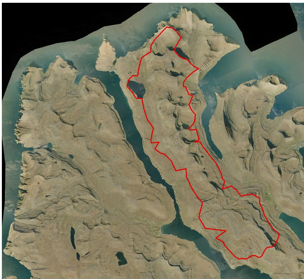
Figur 4 Nedbør som faller innenfor den røde avgrensningen overføres til magasinet Eiðisvatn. Overføringsanlegget består av mer enn 50 km kanaler og borete tunneller med i alt 115 inntak ved bekker.
